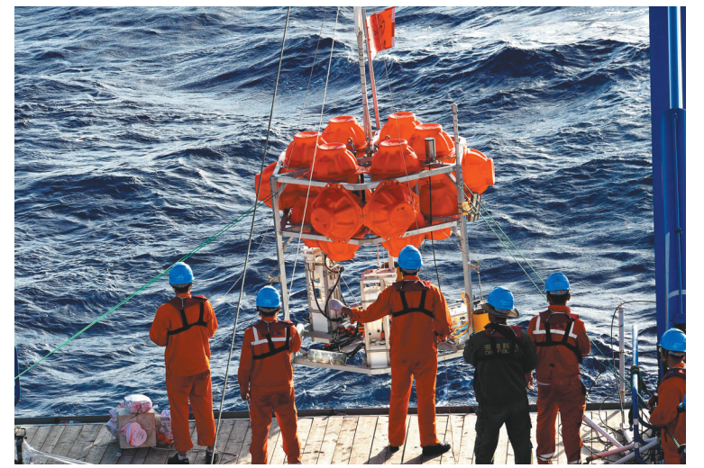
搭载有万米级超短基线定位系统的“彩虹鱼”着陆器被放入海。12月13日,在马里亚纳海沟最深的“挑战者深渊”海域,中国自主研发的万米级水下定位系统——超短基线定位系统,由“彩虹鱼”着陆器搭载成功进行万米级海试,探测深度为10913米,并首次给出超过万米水深的海底精确坐标。 新华社记者 张建松 摄
